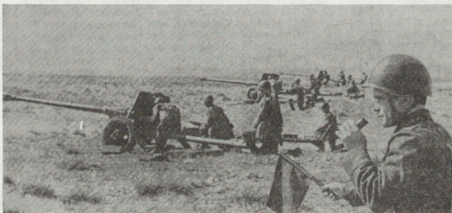
Bild 9. 100-mm-Kanone M-1965, ein leistungsfähiges Mehrzweckgeschütz, sowohl als Feldkanone wie für Panzerabwehr.
