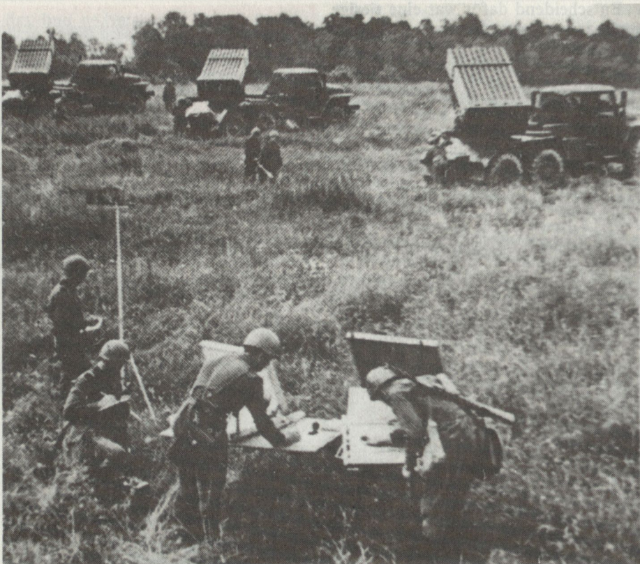
Bild 6. Der 122-mm-Raketenwerfer BM-21, offensichtlich der leistungsfähigste Werfer, der alle «Konkurrenten» ersetzt hat.
