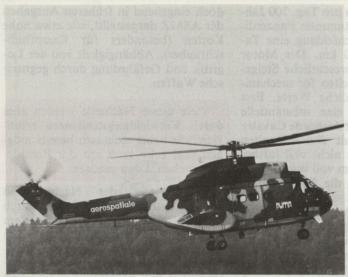
Bild 1. Mehr Aufklärungs-, Transport- und Kampfhelikopter für unsere Armee. Das Bild zeigt den mittelschweren Transporthubschrauber Aerospatial SA 330 Puma für 2 Piloten und 16 bis 20 Soldaten.
