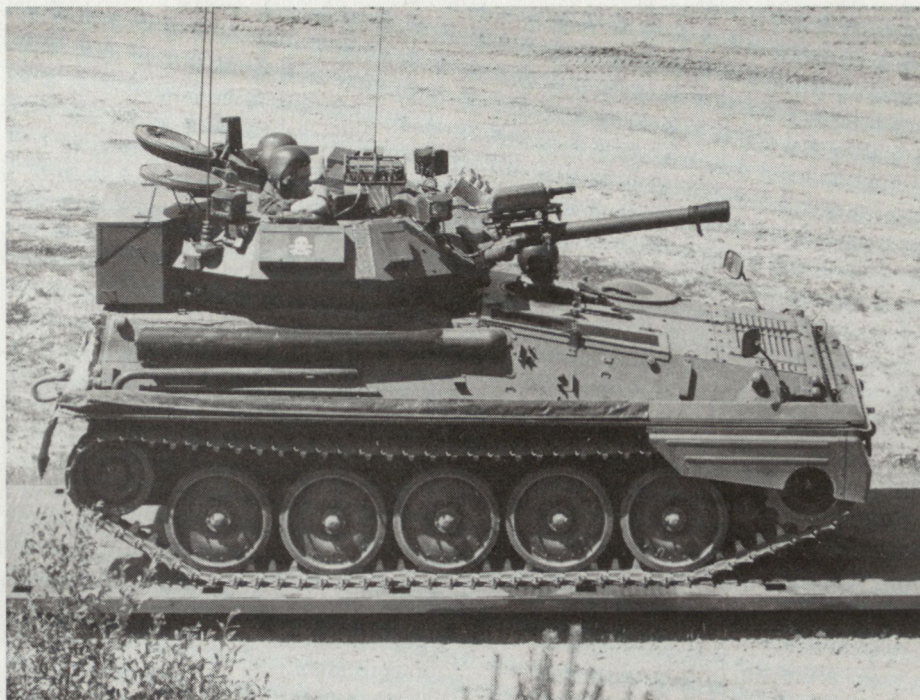
Bild 2. Der leichte Panzer Scorpion der britischen Aufklärungsverbände. Das abgebildete Fahrzeug ist mit dem Schiess-Simulator «Solatron» ausgerüstet.
