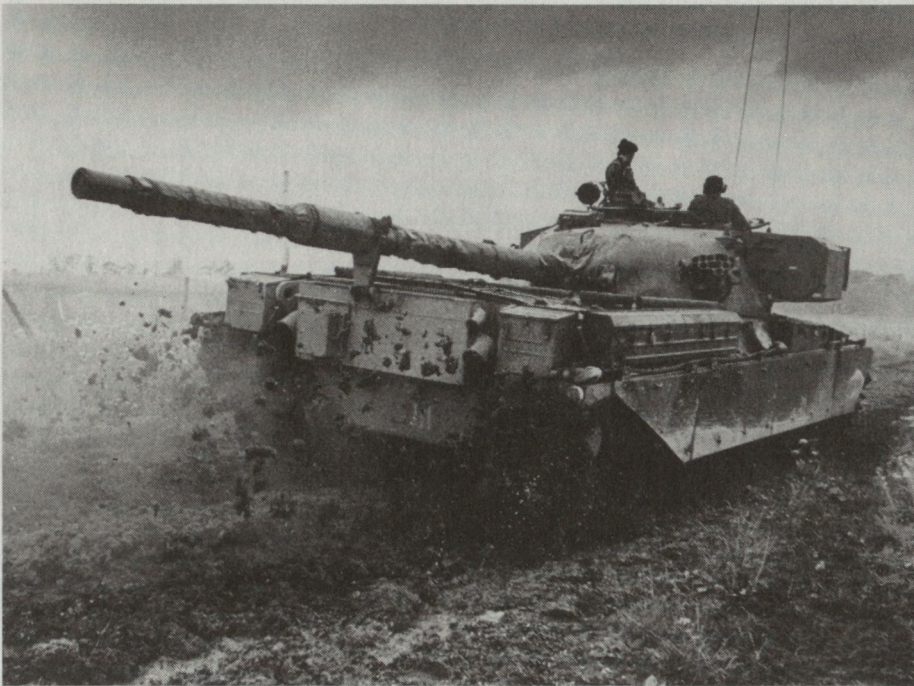
Bild 1. Die britischen Panzertruppen sind mit dem Kampfpanzer Chieftain ausgerüstet. Er verfügt über eine stabilisierte 120-mm-Kanone mit gezogenem Rohr und einem Laser-Entfernungsmesser. Gewicht: 54 Tonnen. Besatzung: 4 Mann.
