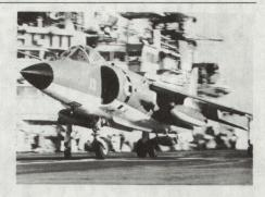
digkeit als beim Kurzstart eine um mehr als 1000 kg erhöhte Nutzlast befördern kann. Das Flugzeug wird mit den Strahldüsen nach hinten gerichtet an der Rampe entlang beschleunigt. Wenn es das Ende der Rampe verlässt, werden die Düsen geschwenkt, so dass sie sowohl Auftrieb als auch Vorwärtsbeschleunigung bedingen.
