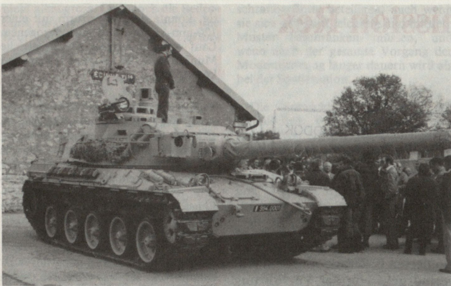
Bild 2. Der AMX 32, von Fachleuten des «Groupement industriel des armements terrestres» präsentiert. Bei der Kanone erkennt man die Öffnung des Laser-Telemeters und die lichtschwache Kamera.
