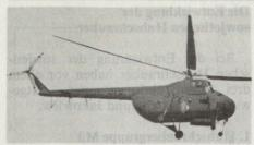
Bild 1. Mittlerer Hubschrauber Mi-4 «Hound» mit zweiteiliger Ladepforte am Rumpfende und Bodenwanne mit oder ohne Bewaffnung unter Rumpfvorderteil.
