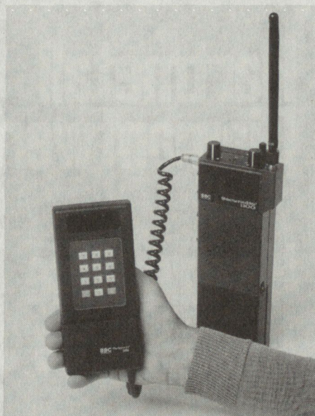
Bild 1. Der «Securadio 1100»: Handfunksprecher mit eingebauter Sicherheit. Im Vordergrund das Code-Eingabemodul. Es wird nur zum Einlesen der Schlüsselkombination benötigt. (Bild BBC)
