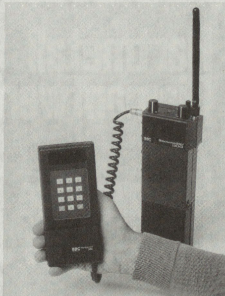
Bild 1. Der «Securadio 1100»: Handfunksprecher mit eingebauter Sicherheit. Im Vordergrund das Code-Eingabemodul. Es wird nur zum Einlesen der Schlüsselkombination benötigt. (Bild BBC)
