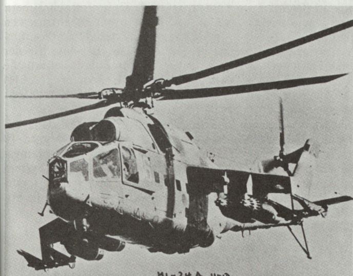
Bild 3. Kampfhubschrauber Mi-24 A Hind der Sowjetunion Reisegeschwindigkeit 300 km/h, Kampfreichweite 320 km, Zuladung 2,8 t und 8-12 Soldaten, Bewaffnung 2/4 x 32 Rak 57 mm, 4 LFK Swatter B/Spiral, 6 Bomben, 1 MK 25-30 mm.
