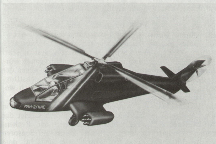
Bild 2. Panzerabwehrhubschrauber PAH 2 Nachtkampffähig. 4,2 t Abfluggewicht, 2 Triebwerke zu 850 KW, 8 HOT Flugkörper, 30 mm MK im Kinn-turm, Luft/Luft FK, Nachtsichtkamera, Avionik, Visionik, Warn- und Störgeräte. Soll ab 1985 den PAH 1 ersetzen.
