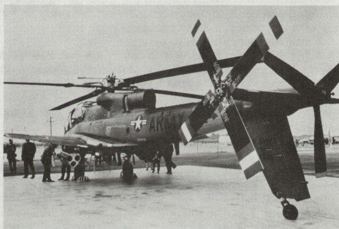
Bild 5. Advanced-Attack-Helicopter (AAH) Cheyenne der USA In den USA bereits seit 1968 mit 10 Prototypen zur Verfügung, voll nachtkampftauglich, Bewaffnung PzAbwLenkRak, MK bis Kaliber 40 mm, ungelenkte Rak und Luft/Luft FKL.
