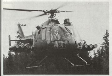
**Bild 1. Panzerabwehrhubschrauber PAH 1**Einsatzfähig nur am Tag. Bewaffnet mit 6 PzAbwLenkRak HOT, ab 1980 im Zulauf zu den 3 PzAbw-Hubschrauber-Regimentern.
