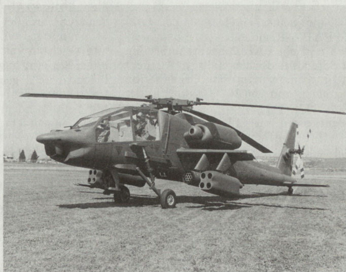
Bild 6. Advanced-Attack-Helicopter (AAH) YAH 64 der USA Seit 1980 im Zulauf zur Truppe, frontreif für den Einsatz bei Nacht und Schlechtwetter, Bewaffnung PzAbwLenkRak und MK sowie ungelenkte Raketen.
