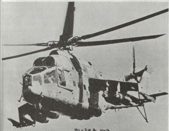
Bild 3. Kampfhubschrauber Mi-24 A Hind der Sowjetunion Reisegeschwindigkeit 300 km/h, Kampfreichweite 320 km, Zuladung 2,8 t und 8–12 Soldaten, Bewaffnung 2/4 × 32 Rak 57 mm, 4 LFK Swatter B/Spiral, 6 Bomben, 1 MK 25–30 mm.
