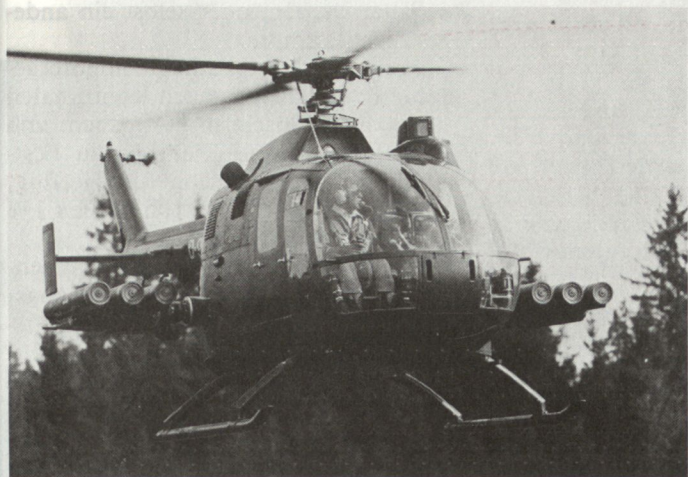
Bild 1. Panzerabwehrhubschrauber PAH 1 Einsatzfähig nur am Tag. Bewaffnet mit 6 PzAbwLenkRak HOT, ab 1980 im Zulauf zu den 3 PzAbw-Hubschrauber-Regimentern.
