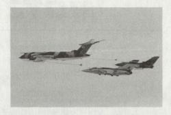
Bild 1 zeigt zwei Tornados bei der Treibstoffaufnahme durch einen RAF-Victor-Tanker. Im Hintergrund sieht man den 15. Tornado (Erdkampfversion), im Vordergrund den Prototyp des F-2 «Air Defence Variant» für die RAF. (Photo Panavia)
