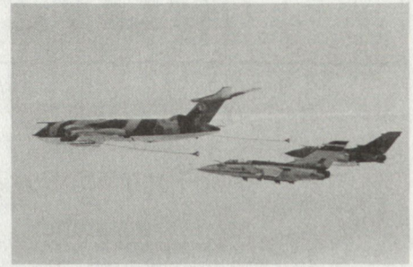
Bild 1 zeigt zwei Tornados bei der Treibstoffaufnahme durch einen RAF-Victor-Tanker. Im Hintergrund sieht man den 15. Tornado (Erdkampfversion), im Vordergrund den Prototyp des F-2 «Air Defence Variant» für die RAF. (Photo Panavia)
