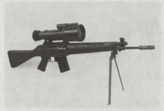
Bild 1: Siemens-Albis-Restlichtverstärker als Ziel- und Beobachtungsgerät für Sturmgewehre.
