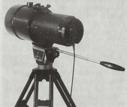
Bild 2: Restlichtverstärker-Kamera (LLL-TV-Kamera) von Siemens-Albis.
