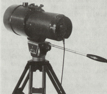
Bild 2: Restlichtverstärker-Kamera (LLL-TV-Kamera) von Siemens-Albis.
