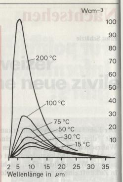
Bild 3: Spektrale Intensitätsverteilung der Strahlung eines schwarzen Körpers.
