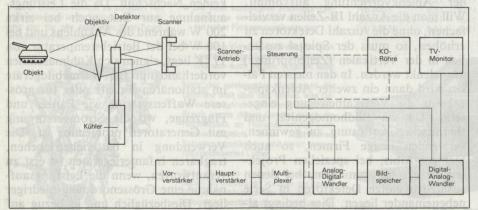
Bild 6: Prinzipielle Funktionsweise eines Wärmebildgerätes mit elektronischem Multiplexing.
