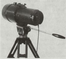
Bild 2: Restlichtverstärker-Kamera (LLL-TV-Kamera) von Siemens-Albis.
