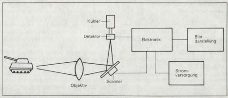
Bild 4: Grundaufbau eines Wärmebildgerätes.
