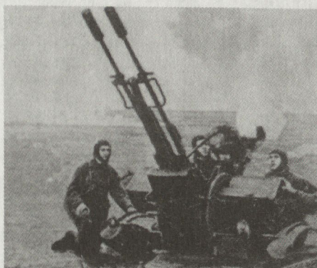
Bild 17. 23-mm-Zwillings-Flab, etwa seit 1965 bei der Truppe, im Erdkampf ebenso wirksam wie in der Abwehr von Tieffliegern.
