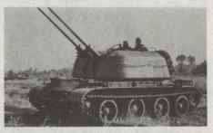
Bild 19. Panzerflab ZSU 57-2 mit Zwillingsrohren vom Kaliber 57 mm, kein Radargerät.
