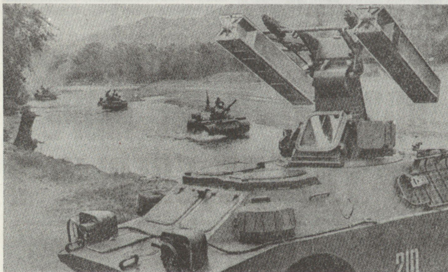
Bild 24. Flab-Raketensystem SA-9 Gaskin, vor allem zur Tieffliegerabwehr eingesetzt.
