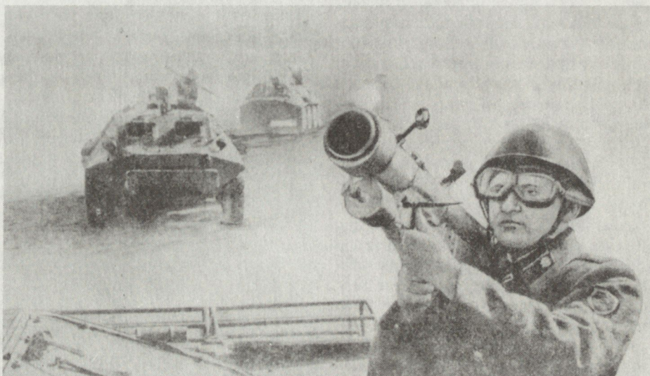
Bild 22. SA-7 Grail, die «Fliegerfaust» der sowjetischen Landstreitkräfte. Erreicht Flugziele bis 3000 m Höhe und bis ca. 4000 m Entfernung.
