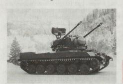
zers 68 aufgebaut. Die Bewaffnung besteht aus zwei 35-mm-Kanonen und einem integrierten, radargesteuerten Feuerleitsystem.
