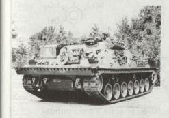
Besonderes Kennzeichen des Bergepanzers 2 (leistungsgesteigert) ist die zusätzliche Abstützmöglickeit über eine neue Heckstütze (bisher nur Frontschaufel). Mit 16 Tonnen zulässiger Schwenklast wurde ein Mehr gegenüber der Standardversion von ungefähr 25% erzielt. Weiterhin wurde die Seilausfahrgeschwindigkeit der Winde der Schrittgeschwindigkeit gepanzerter Fahrzeuge angeglichen. Hierdurch kann das Bergefahrzeug Panzerfahrzeuge beim Tiefwaten und Unterwasserfahren sichern.
