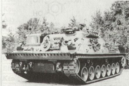
Besonderes Kennzeichen des Bergepanzers 2 (leistungsgesteigert) ist die zusätzliche Abstützmöglichkeit über eine neue Heckstütze (bisher nur Frontschaufel). Mit 16 Tonnen zulässiger Schwenklast wurde ein Mehr gegenüber der Standardversion von ungefähr 25% erzielt. Weiterhin wurde die Seilaufahrgeschwindigkeit der Winde der Schrittgeschwindigkeit gepanzelter Fahrzeuge angeglichen. Hierdurch kann das Bergefahrzeug Panzerfahrzeuge beim Tiefwaten und Unterwasserfahren sichern.
