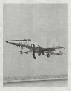
Auf dem Bild erkennt man zwei Vförmige Kamerafenster vor dem Bugrad, zwei flache Fenster im Bug-Vorderteil und ein nach vorne gerichtetes Fenster in der Bugspitze. pb
