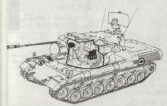
Bild 2. Fahrzeug-Navigationsanlage eingebaut in Flak Pz Gepard.
