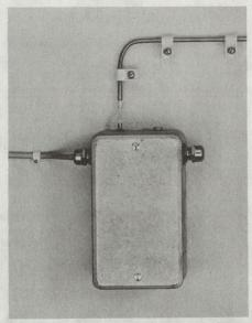
Bild 1a. Kontaktgehäuse mit angeschlossenem Fühlerrohr
