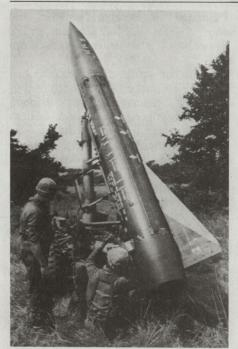
Bild 2: Lance auf Startgerät M-740 gezogen
