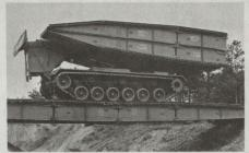
Bild 2: Brückenpanzer beim Flussübergang
