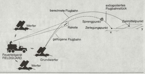
Um die Gegenseite nicht vor dem kommenden Feuerschlag zu warnen, können die Raketen nach einer bestimmten Flugstrecke zerlegt werden. Dank dem gespeicherten Flugbahnmodell der Rakete wird der Rest der Flugbahn, oder anders ausgedrückt, der mittlere fiktive Treffpunkt der Raketen durch Extrapolation ermittelt.
