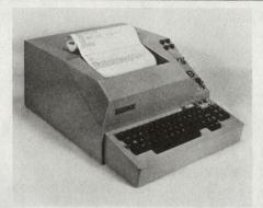
Die Elektronik besteht aus fünf Steckkarten – vier steuern die Mechanik, die fünfte sorgt für umfangreiche Satz- und Redigiermöglichkeiten. Ferner verfügt der Fernschreiber über einen Halbleiter-Nachrichtenspeicher, der mit einer Speicherkapazität von 4000 oder 12 000 Zeichen erhältlich ist.
