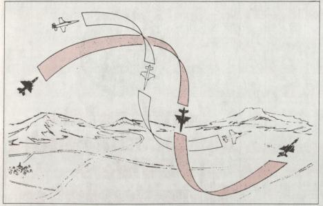
Bild 6. Beispiel eines einfachen Luftkampfablaufes von je einem eigenen (weiss) und feindlichen (rot) Flugzeug. Abwehrwalze mit grosser Beschleunigung, die den Gegner zum Vorschiessen zwingen soll.
