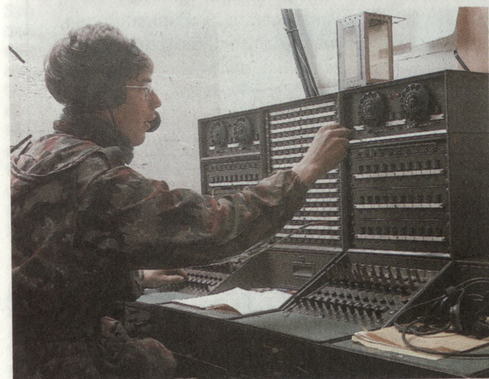
Von oben nach unten: Motorisierter Bau einer Zweidraht-Feldleitung. Trägerfrequenzrüstung für vier Kanäle. Handvermittelte Telefonzentrale für Grosse Verbände.
