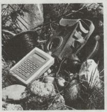
das handliche Memoport-Terminal im Taschenformat eingetippt. Bis zu 8000 Zeichen haben darin Platz. Zur Übertragung zur Memoport-Zentrale dient das normale Telefon-oder Funknetz. Man stülpt die Akustikmuffe über das Mikrofon und löst durch einfachen Tastendruck die Übertragung aus. Allfällige Übertragungsfehler werden mit
