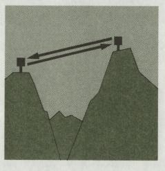
Gegenstation wirft das von der Hauptstation ausgesandte Signal wieder zurück. Die exakte Entfernungsbestimmung erfolgt über einen Phasenvergleich der jeweiligen »Mass-Stab-Frequenzen«. Eine eingebaute Sprechgarnitur dient zur gegenseitigen Verständigung des Bedienungspersonals. Das Gerät ist robust, zuverlässig und für einen wirtschaftlichen Unterhalt konstruiert.
