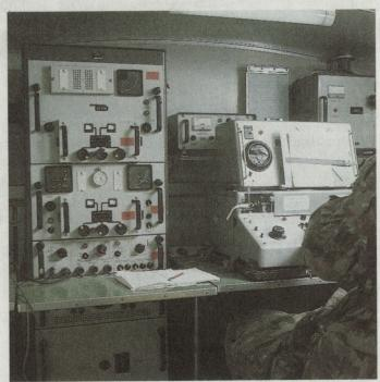
Von oben nach unten: Telefonzentrale in permanenten militärischen Netzen (PMZ). Kompakter Sender-Empfänger SE-412 für Führungsnetze. Fernschreibstation mit eingeschlauftem Verschlüsselungsgerät.
