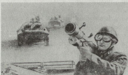
Bild 5. SA-7 Grail, die «Fliegerfaust» der sowjetischen Landstreitkräfte. Erreicht Flugziele bis 3000 m Höhe und ca. 4000 m Entfernung.
