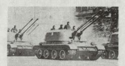
Bild 2. Vierling ZSU 23-4, ein leichtes Fla-Geschütz auf Selbstfahrlafette. Seit etwa 1965 im Einsatz. Sehr leistungsfähig im Erdkampf und in der Luftabwehr.
