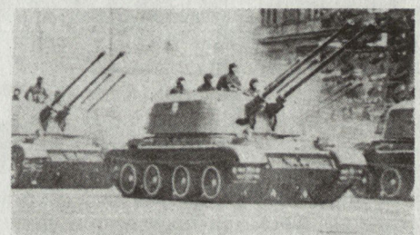
Bild 2. Vierling ZSU 23-4, ein leichtes Flak-Geschütz auf Selbstfahrlafette. Seit etwa 1965 im Einsatz. Sehr leistungsfähig im Erdkampf und in der Luftabwehr.
