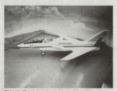
Bild 8: Projekt eines Jägers mit nach vorne gepfeiltem Flügel (USA).
