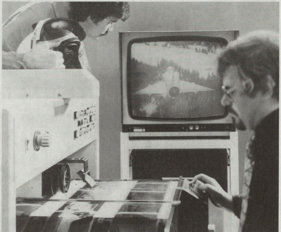
Bild 1. Das elektronische Auswertegerät REVI II: Im Vordergrund das Durchleuchtpult mit den Filmführungen, im Hintergrund der Bildmonitor
