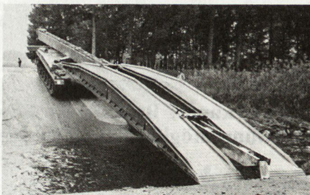
Bild 4. Ausfahren der Brücke mittels Schiebewagen
