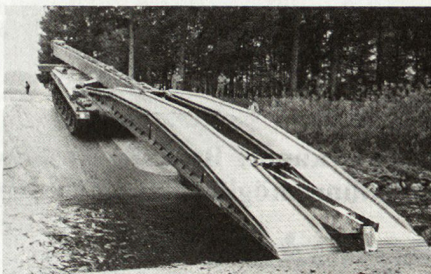
Bild 4. Ausfahren der Brücke mittels Schiebewagen
