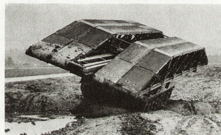
Bild 2. Brückenpanzer 61 mit MAN-Genieschiebebrücke
