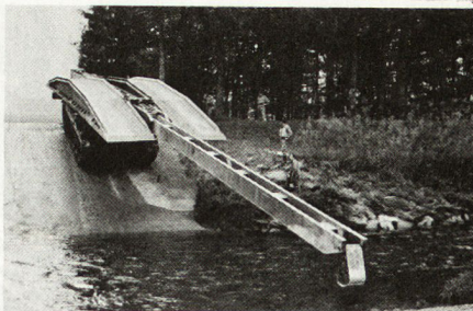
Bild 3. Ausfahren der Führerstütze
