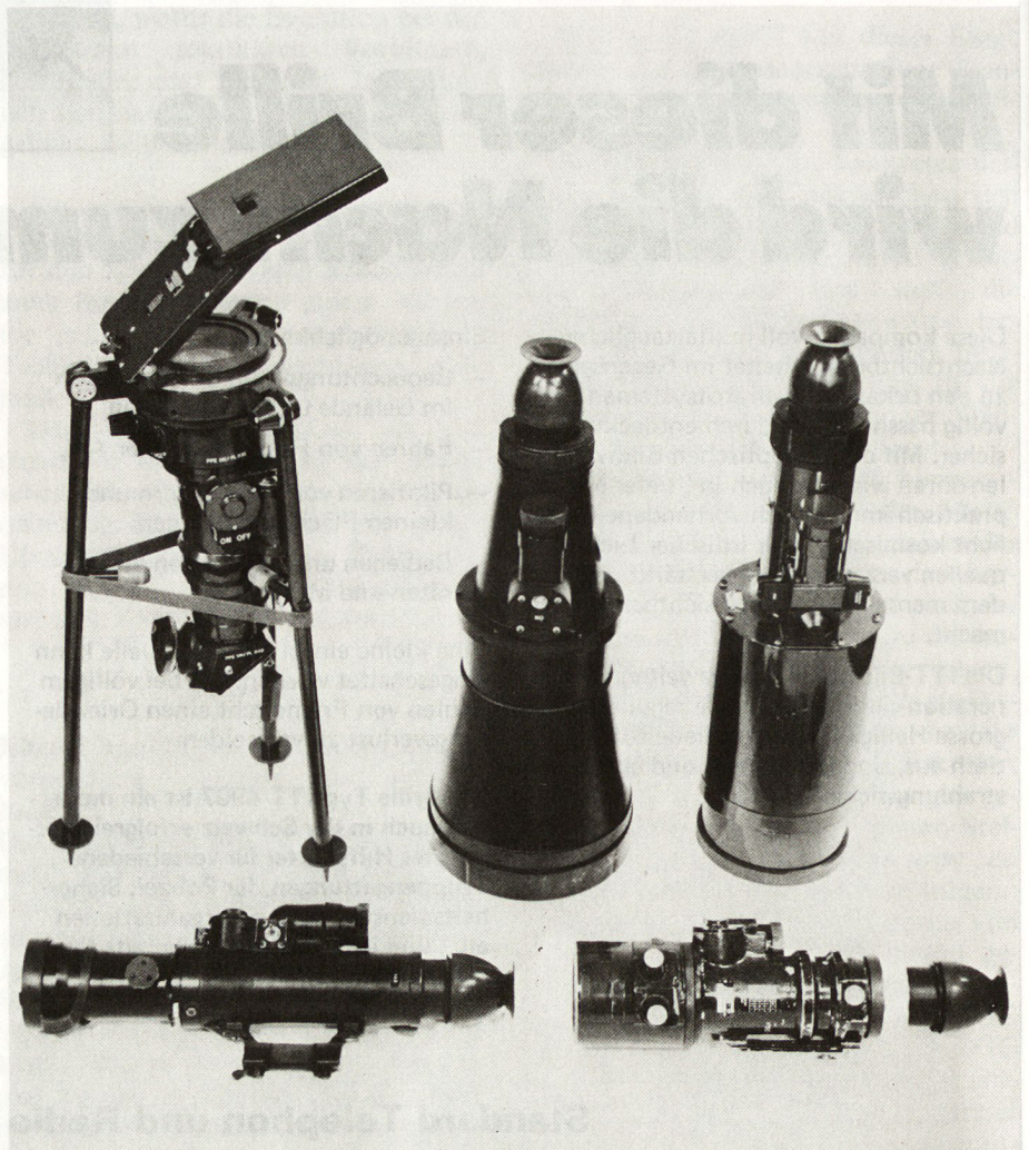
Bild 1. Oben, links beginnend: Spartan-Nachtsichtgerät, Nachtsichtgerät Kat. B, Sichtgerät für Kollektivwaffen. Unten: Sichtgerät für persönliche Waffe, Nimtam.
