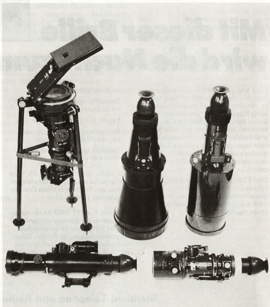
Bild 1. Oben, links beginnend: Spartan-Nachtsichtgerät, Nachtsichtgerät Kat. B, Sichtgerät für Kollektivwaffen. Unten: Sichtgerät für persönliche Waffe, Nimtam.
