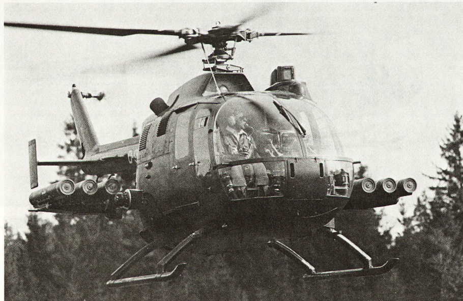
Bild 26. Panzerabwehrhubschrauber (PAH) mit 6 Pzaw-Lenkflächenraketen «HOT»; ab Ende der siebziger Jahre
