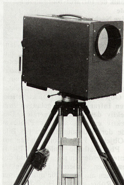
Bild 4. Wärmebildgerät (WBG 2) mit einer Temperaturauflösung von 0,1° K.
