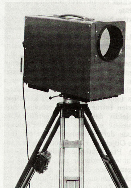
Bild 4. Wärmebildgerät (WBG 2) mit einer Tempurauflösung von 0,1° K.
