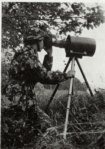
Bild 2. Restlicht aus der Atmosphäre genügt diesem Beobachtungsgerät (RDS 400/200) zur Szenenbeleuchtung.
