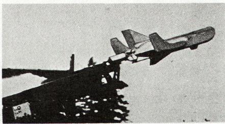
Länge von 2,38 m, eine Spannweite von 1,72 m, eine Höhe von 0,93 m, ein Startgewicht von 147 kg auf.
