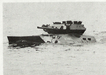
Bild 4. Angetrieben durch zwei große Schrauben, erreichen die Mowag «Piranha» Wasserfahrgeschwindigkeiten von bis zu 12 km/h.
