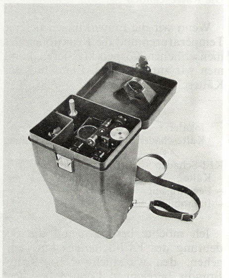
Bild 3. Fernrohr und Kleinstativ, in Tragbehälter verpackt.
