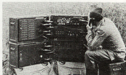
Für mobile Anwendungen ausgelegt ist die vielseitig verwendbare rechnergesteuerte Vermittlungsstation, die Telephonbau und Normalzeit zusammen mit Siemens entwickelte.
