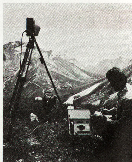
Innerhalb von 30 Sekunden mißt der Mikrowellendistanzmesser «Sial MD 60» von Siemens-Albis Strecken von 20 m bis 150 km.
