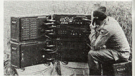
Für mobile Anwendungen ausgelegt ist die vielseitig verwendbare rechnergesteuerte Vermittlungsstation, die Telephonbau und Normalzeit zusammen mit Siemens entwickelte.
