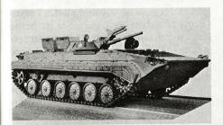
Bild 1. Der sowjetische BMP mit 73-mm-Kanone. Koaxiales 7,62-mm-Maschinengewehr, Abschußrampe für «Sagger».
