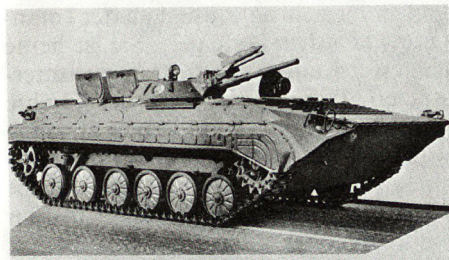
Bild 1. Der sowjetische BMP mit 73-mm-Kanone. Koaxiales 7,62-mm-Maschinengewehr, Abschlußrampe für «Sagger».
