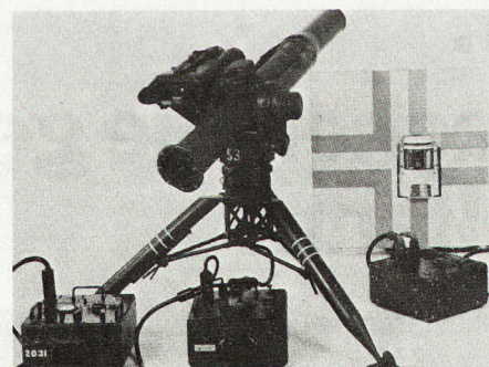
Bild 8. «Tow» mit Ausbildungsausrüstung für Simulation.
