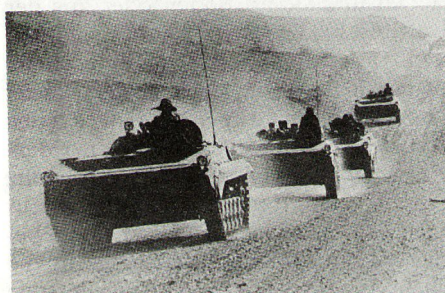
Bild 2. Kampfschützenpanzer BMP in Fahrt, ohne «Sagger».
