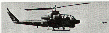
Bild 14. «Tow»-Abschuß vom Panzerabwehrhelikopter AH 1 Q.
