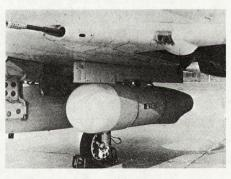
auf. Der WX 50 ergibt eine genaue Bodenbilddarstellung bis zu einer Distanz von 56 km und kann den vor dem Flugzeug liegenden Sektor abtasten. Diese Betriebsart läßt einen sicheren Sinkflug bis zu einer Höhe von 183 m über Grund zu. Die Informationen werden auf dem Radarbildschirm in Flach-E-Form dargestellt, wobei der Flugzeugstandort konstant ist und das Geländebild von
