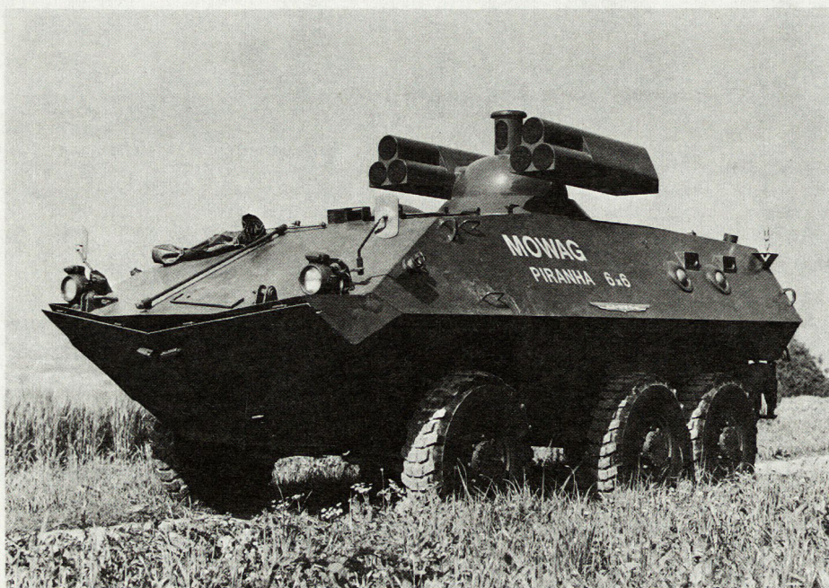
Das als Raketenjagdpanzer konzipierte Radfahrzeug Mowag «Piranha» 6 × 6.
