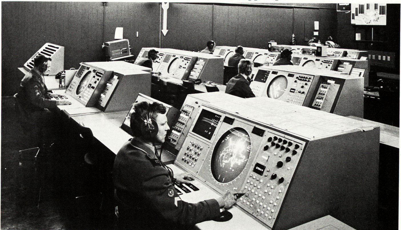
Unten: In der «Florida»-Einsatzzentrale werden alle ermittelten Daten automatisch dargestellt und liefern dem Verantwortlichen die Entscheidungsgrundlagen.
