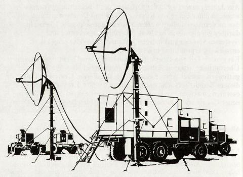
Fig. 3. Richtstrahlgerät mit Troposcatterzusatz.
