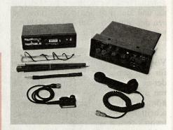
Fig. 10. Tornisterfunkgerät SE-226 mit abgetrenntem Akkumulator und Zubehör
