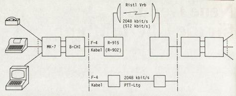
Fig. 1. Zusammenwirken von MK-7, Bündelchiffriergeräten, R-915 (R-902) und 2048 kbit/s PTT-Ltg.
