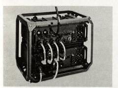
Fig. 5. Beispiel eines MK-7-Gerätes mit Schwingrahmen.
