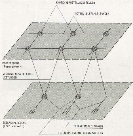
Fig. 6. Mögliche IBEX-Netzstruktur.
