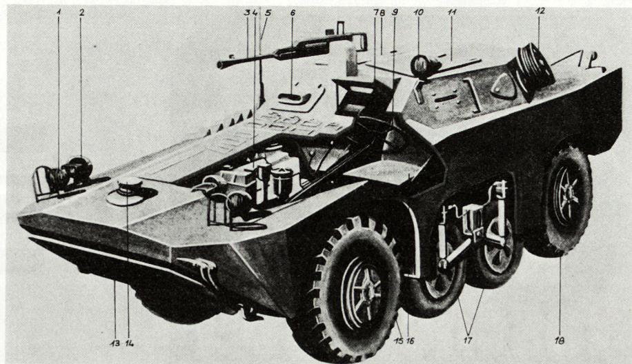
angetrieben. Mit dem 90-PS-Motor wird eine Höchstgeschwindigkeit von 80 km/h erreicht. Im Wasser beträgt die Geschwindigkeit 9 km/h. Im Fahrerraum, im Mittelteil des SPW (der Motor ist vorn), sind neben den Plätzen für den Fahrer und den Kommandanten alle Bedienungselemente, die Beobachtungsgeräte, die Kontrollgeräte und die Funkstation.
