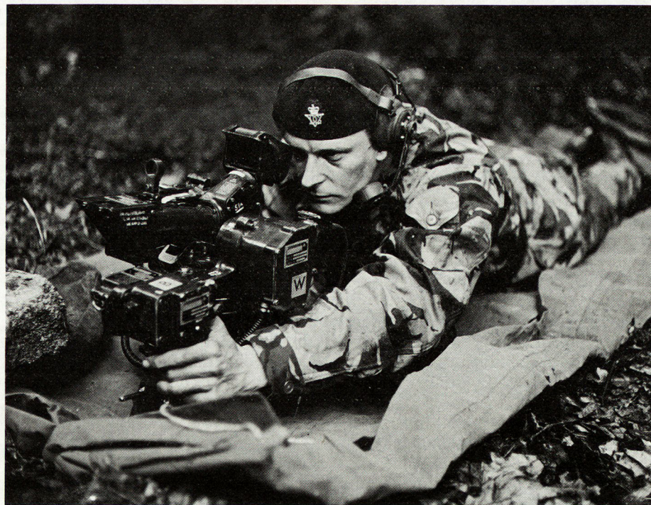
Bild 2. Britischer Schütze mit Zielgerät der drahtgelenkten Panzerabwehrwaffe «Swingfire».
