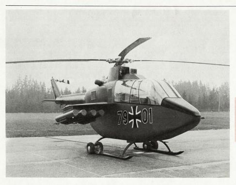
Leichter Panzerabwehrhubschrauber Bo 115 der Firma Messerschmitt-Bölkow-Blohm. Abfluggewicht etwa 2,5 t, Bewaffnung bis zu 8 Panzerabwehrlenkraketen. Zwei Turbinen.
