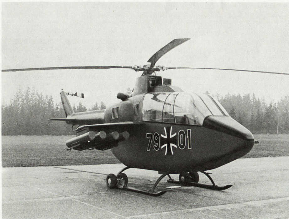
Leichter Panzerabwehrhubschrauber Bo 115 der Firma Messerschmitt-Bölkow-Blohm. Abfluggewicht etwa 2,5 t, Bewaffnung bis zu 8 Panzerabwehrlenkkraketen. Zwei Turbinen.
