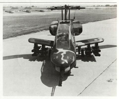
Advanced Attack Helicopter (AAH) YAH 63 der Firma Bell (USA). Abfluggewicht 7 bis 8 t, zwei Turbinen zu 1500 PS, Bewaffnung bis zu 16 Panzerabwehrlenkraketen beziehungsweise Mischbewaffnung aus gelenkten und ungelenkten Raketen sowie Maschinenkanonen. Forward Looking Infrared (FLIR) für Einsatz bei Tag und Nacht.
