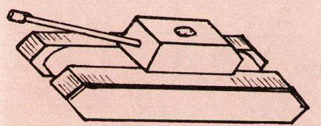
**3.** Die Panzerung besteht aus 10 bis 15 cm dicken Stahlplatten. Ein Pz ist ein «mobiles Schützenloch».
