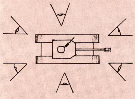
**2.** Pz verfügen zusätzlich über ein geschützparalleles Mg sowie über ein Flab-Mg. Die Sicht ist beschränkt. Kampflärm kann die Pz Besatzung schlecht wahrnehmen. (Schußtoter Raum v: 4 bis 20 m, h: 30 bis 50 m).
