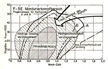
Die Flugenveloppe (Bild 3) bestätigt auch beim F 5E die Tendenz, die Kampfbewegungen mehrheitlich in den hohen Unterschallbereich zu verlegen, wie dies übrigens auch bei typischen Hochleistungsflugzeugen der Mach-2+-Klasse der Fall ist. Für den Raumschutz in Höhen bis zu etwa 3000 bis 4000 Meter ü. M. dürfte dies ganz besonders zutreffen, wo Beweglichkeit, Beschleunigungs- und Steigvermögen von ausschlaggebender Bedeutung sind.
