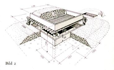
Der Kopfschutz (vergleiche Bild 2) über dem Kampfstand des Zweimann-Schützenloches bietet einen wirksamen Schutz vor Geschoßsplittern. Der Kopfschutz läßt den Handgranatenwurf aus dem Schützenloch nicht zu. Dafür können aus dem Grabensystem überall Handgranaten geworfen werden. Ob und wann der Kopfschutz gebaut werden soll, ist ein Kommandantenentscheid. Der Kopfschutz muß sorgfältig getarnt werden.
