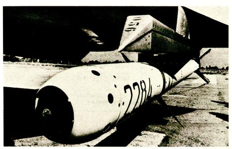
Die Lenkwaffe «Shafrir» ist an der Waffenstation unter dem Flügel des Kampfflugzeugs «Mirage III E I» aufgehängt.
