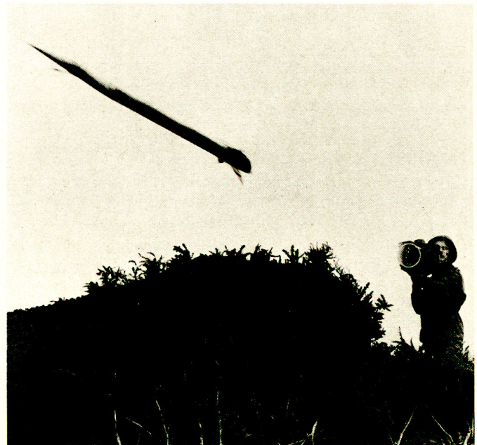
Bild 1. Die Einmannlenkwaffe «Blowpipe» kurz nach dem Verlassen des Abschubrohres.
