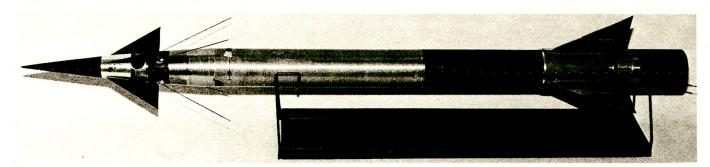
Bild 3. Links der bewegliche Kopf mit Zünder und Steuerflächen, dahinter die Empfangsantennen. In der Mitte die Sprengladung. Am Heck das zweistufige Triebwerk und die Stabilisierungsflächen.
