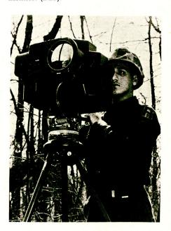
Von derselben Firma ist ein für die US-Army bestimmtes Nachtsichtgerät NODLR (Night Observation Device, Long Range) entwickelt worden. Das Gerät kann bei völliger Dunkelheit eingesetzt werden und ergibt ein TV-ähnliches Bild. Das transportable und mit einer Batterie gespeiste NODLR-Gerät kann, auf Fahrzeugen oder auf Stativ montiert, bei sehr großem Gesichtsfeld Truppen, Fahrzeuge
