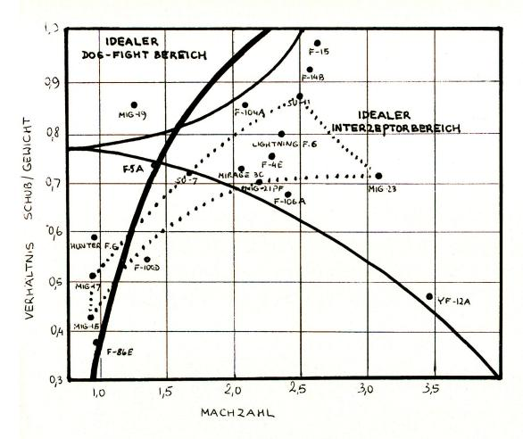
Bild 6. Die Fähigkeit, erfolgreiche Interzeptionen und dog fight gleichermaßen optimal durchzuführen, werden von zwei Faktoren am stärksten beeinflußt: Machzahl und Beschleunigung. Die Beschleunigung ist im wesentlichen ein Produkt des Schub/Gewichts-Verhältnisses.
