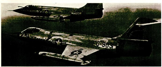
Bild 3. Der F 104A war der erste Mach-2- (Tag-) Interzeptor der Welt. Die Hauptbewaffnung bestand aus einer sechsläufigen Revolverkanone rechts im Bug und zwei «Sidewinder»-Lenkwaffen. Die europäische Version F 104G und der kanadische CF 104 sind hingegen Mehrzweck-
