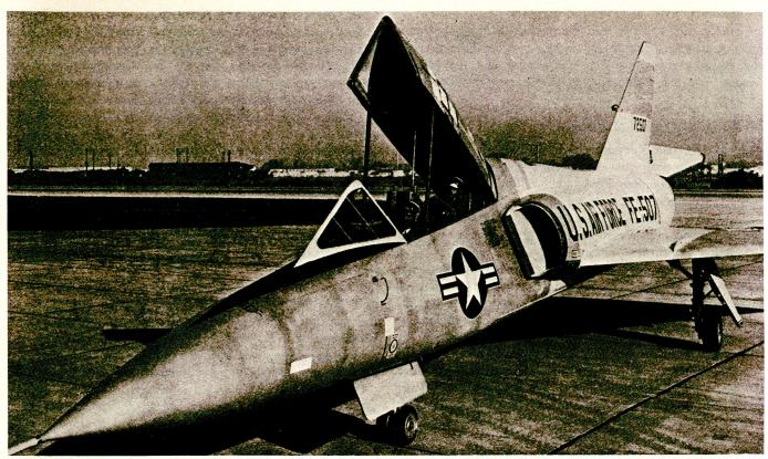
Bild 4. Mit einer Spitzengeschwindigkeit von über 2300 km/h und einer praktischen Dienstgipfelhöhe von 19 000 m hat der schwere Luftverteidigungsjäger F 106 «Delta Dart» bei Mach 0,85 eine Reichweite von 4 Stunden, dazu besteht die Möglichkeit der Luftbetankung. Der F 106
