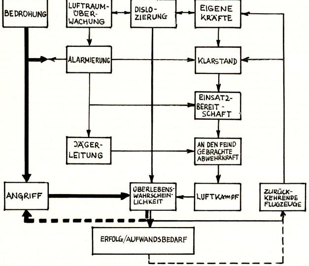
Bild I. Ermittlung des Aufwandsbedarfes eines Luftverteidigungssystems. An Hand der ermittelten eigenen und gegnerischen Kräfte läßt sich für einen Konfliktsfall (mit variabler Größenordnung) die Wirksamkeit eines Luftverteidigungssystems für einen bestimmten Raum ermitteln. Unter Festlegung einer Abnützungsrate kann unter einer Vielzahl
