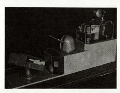
Bild 2. Das WS «Albatros» besteht aus Feuerleitgeräten, Geschützen, Achtfachstartern und den Lenkwaffen «Sea Sparrow».
